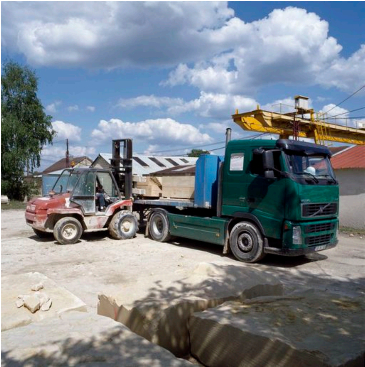
Chargement des blocs de pierre (carrière Ouachée-Corpechot, Saint-Maximin).
