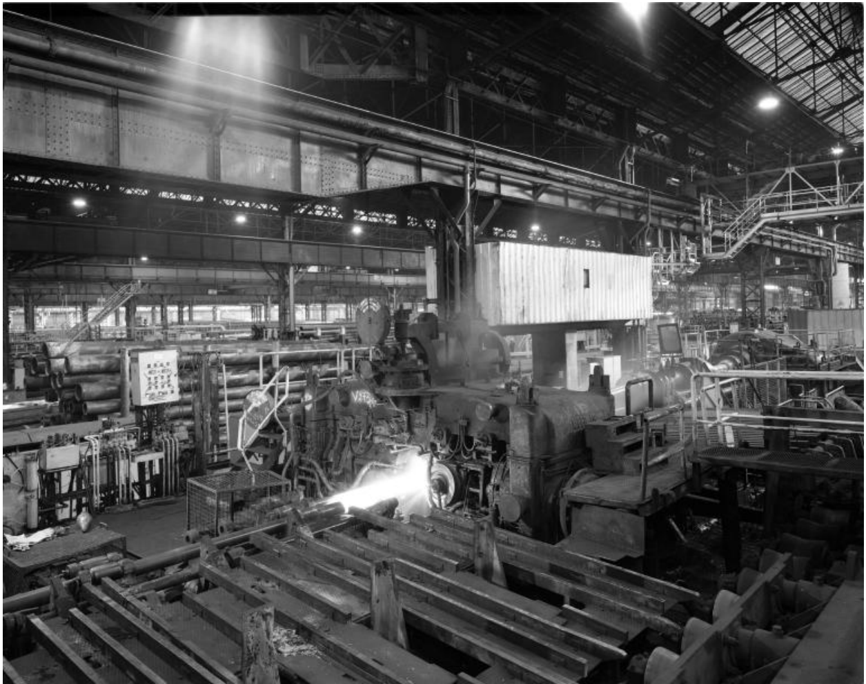
Les laminoirs (usine C). Vue générale du perceur Meer-Mannesmann AG, datant des années 1930. Au premier plan, le tube en cours de percement.
