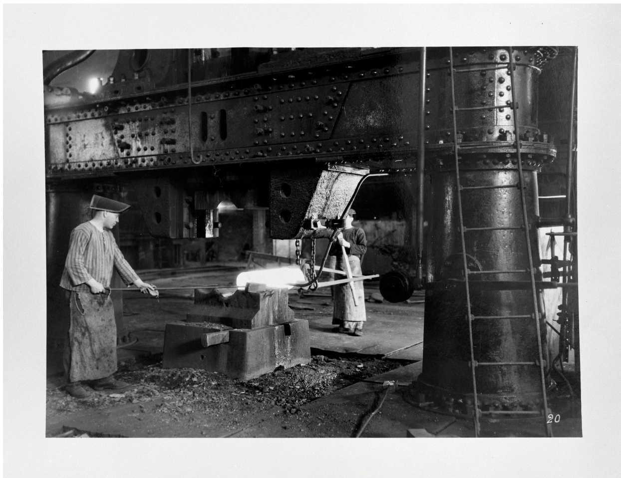
Atelier de bandages ou d'essieux : vue générale d'un marteau-pilon. Photographie ancienne, auteur inconnu, sans date (coll. part.).
