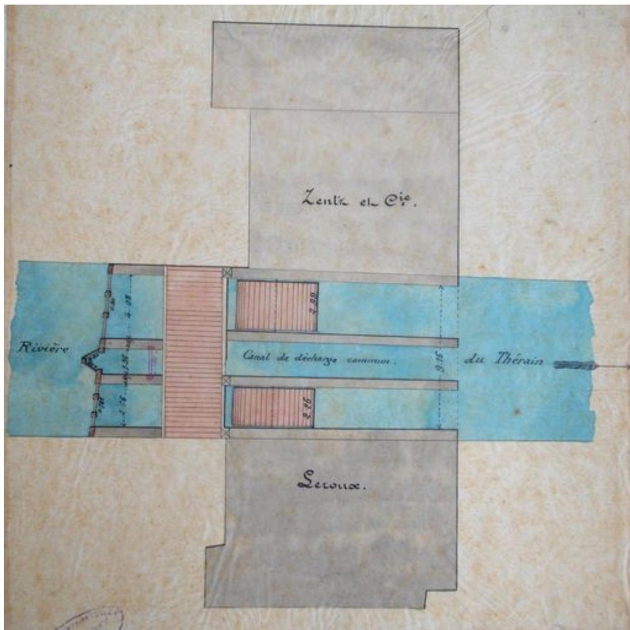
Plan annexé à la demande des sieurs Zentz et Leroux pour la modification des vannes de décharge de leur usine, par Lecoer (ingénieur des Ponts-et-Chaussées), 1884.
