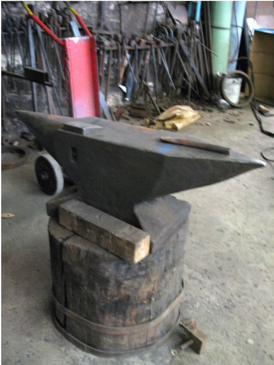
Machine à forger libre (enclume).
