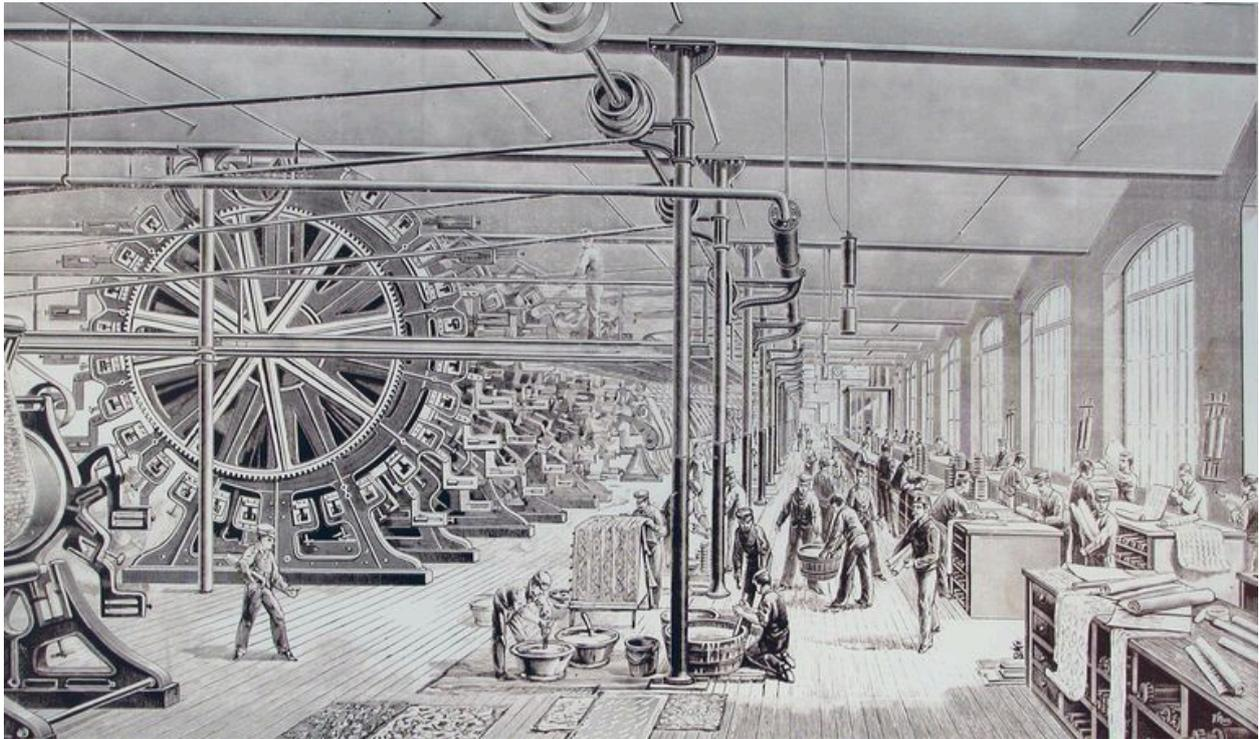
Vue intérieure de l'atelier de fabrication, avec la machine à imprimer à vingt-quatre couleurs en place.
