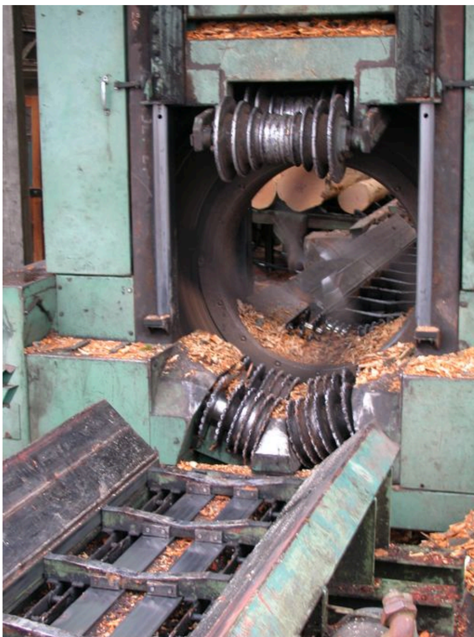
Machine à écorcer les grumes avant sciage.
