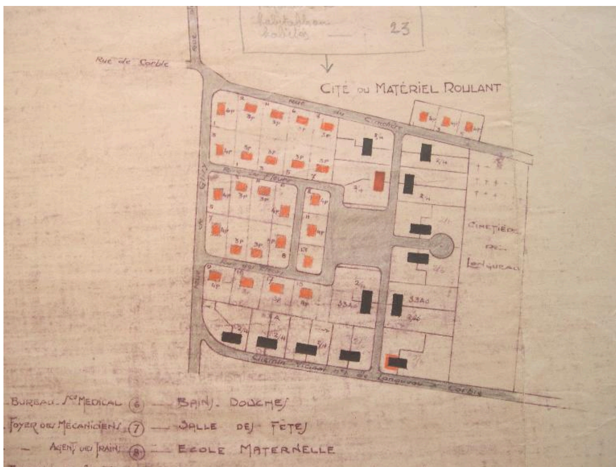
Plan de la cité, vers 1947 (AD Somme ; 15J 98). En noir, les maisons existantes, en orange les maisons à construire, de type VB.
