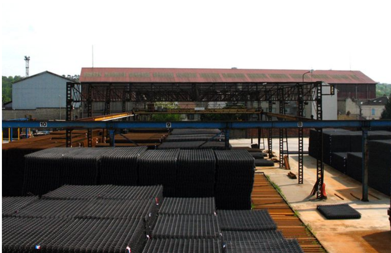
Vue depuis le pont-roulant des aires de stockage des treillis-soudés.
