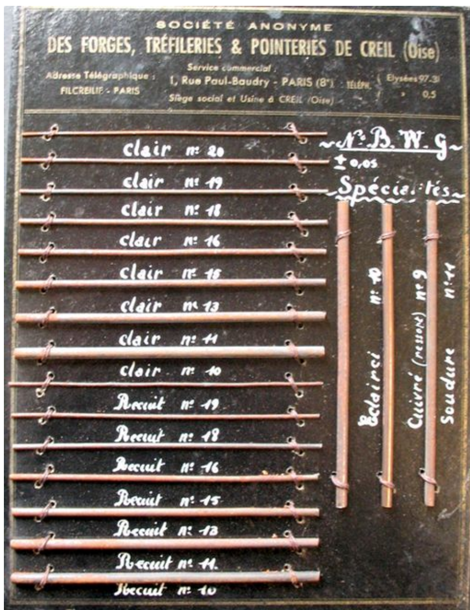
Echantillon de fils produits à la tréfilerie.
