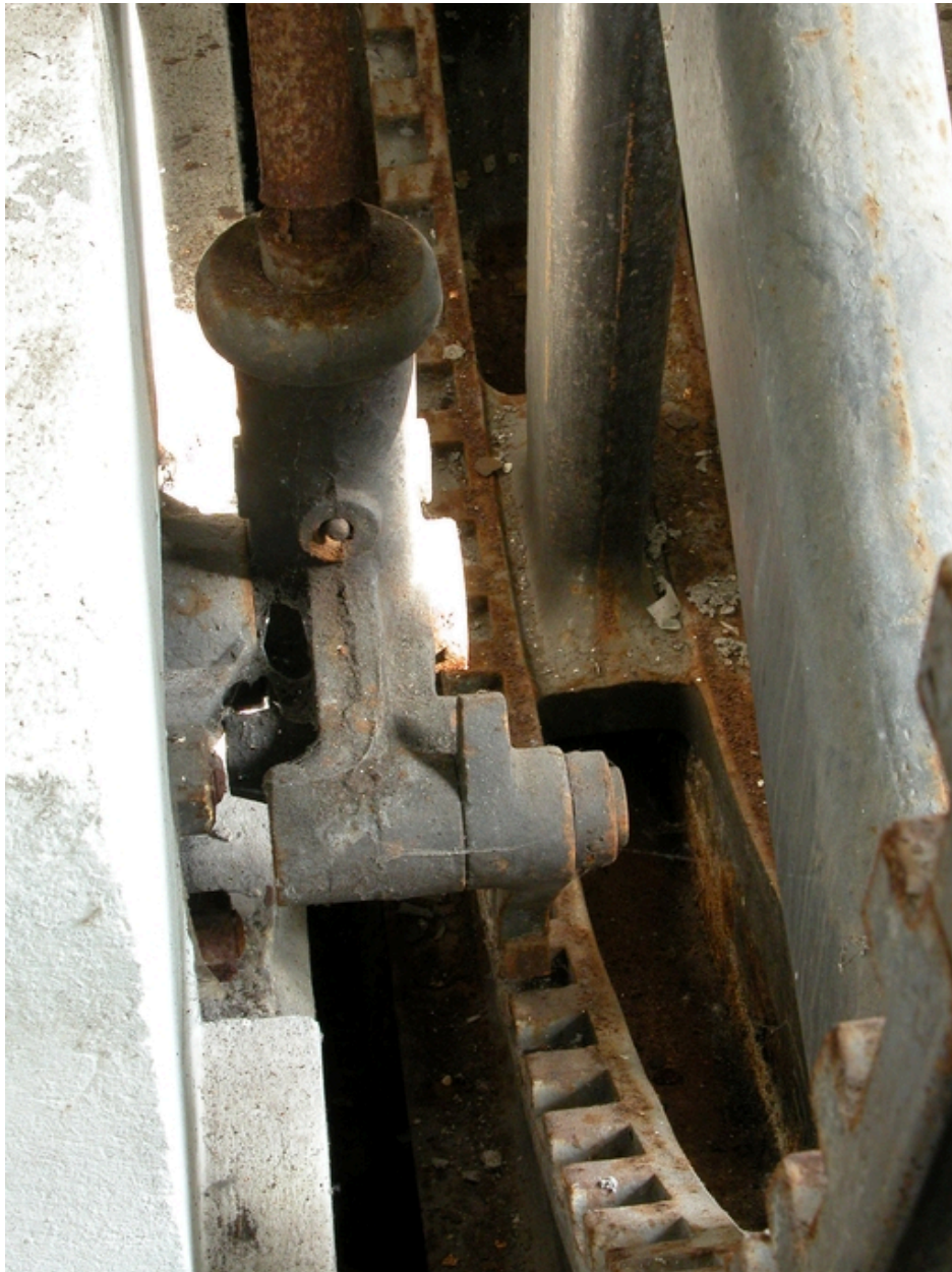
Mécanisme manuel de blocage du volant.
