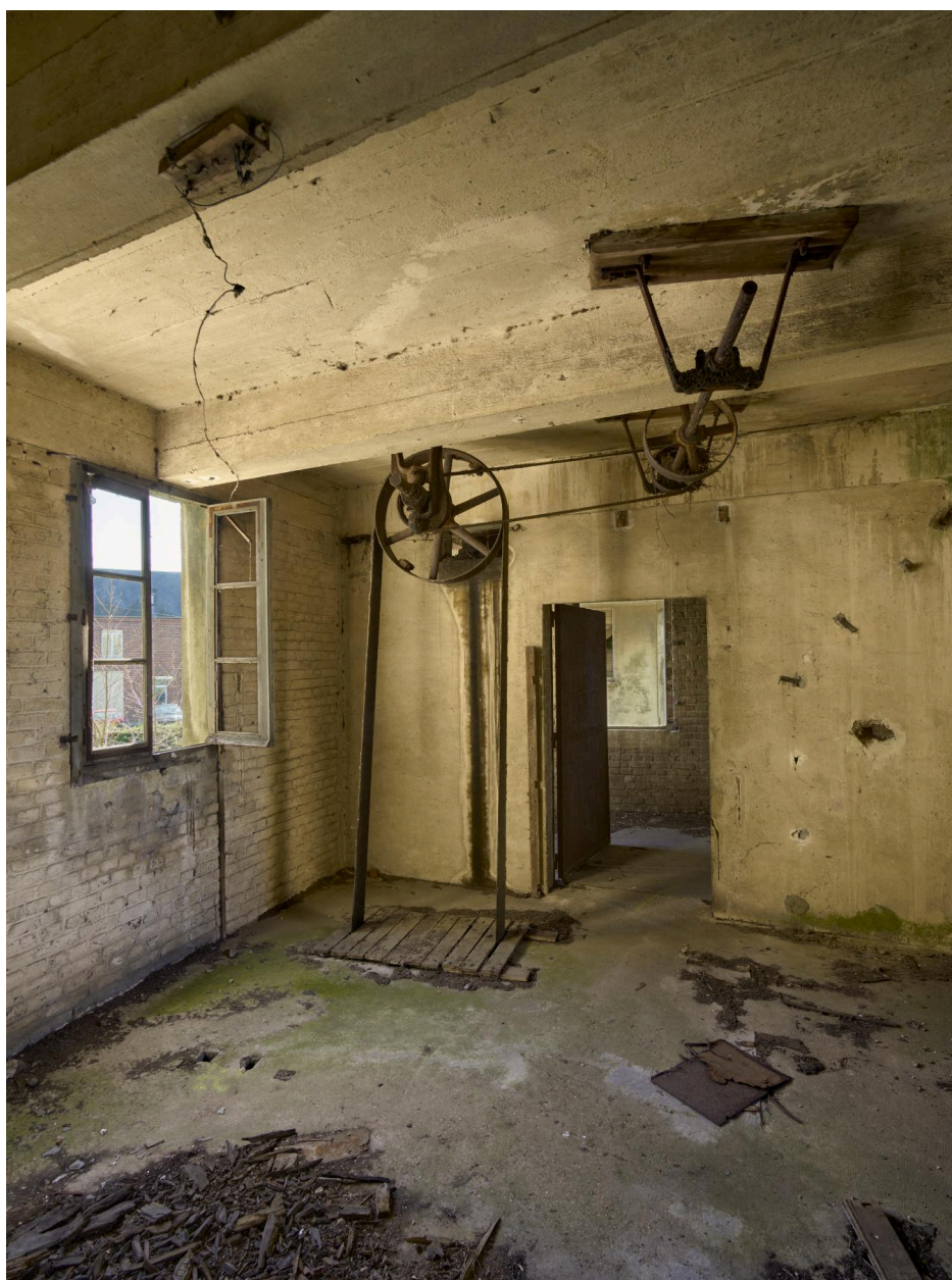
Arbre de transmission, poulies et courroies.
