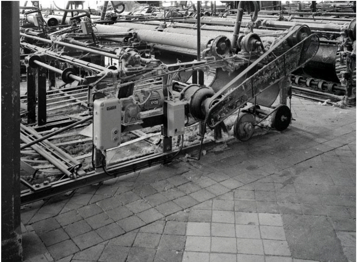
Détail d'une machine à couper le velours.
