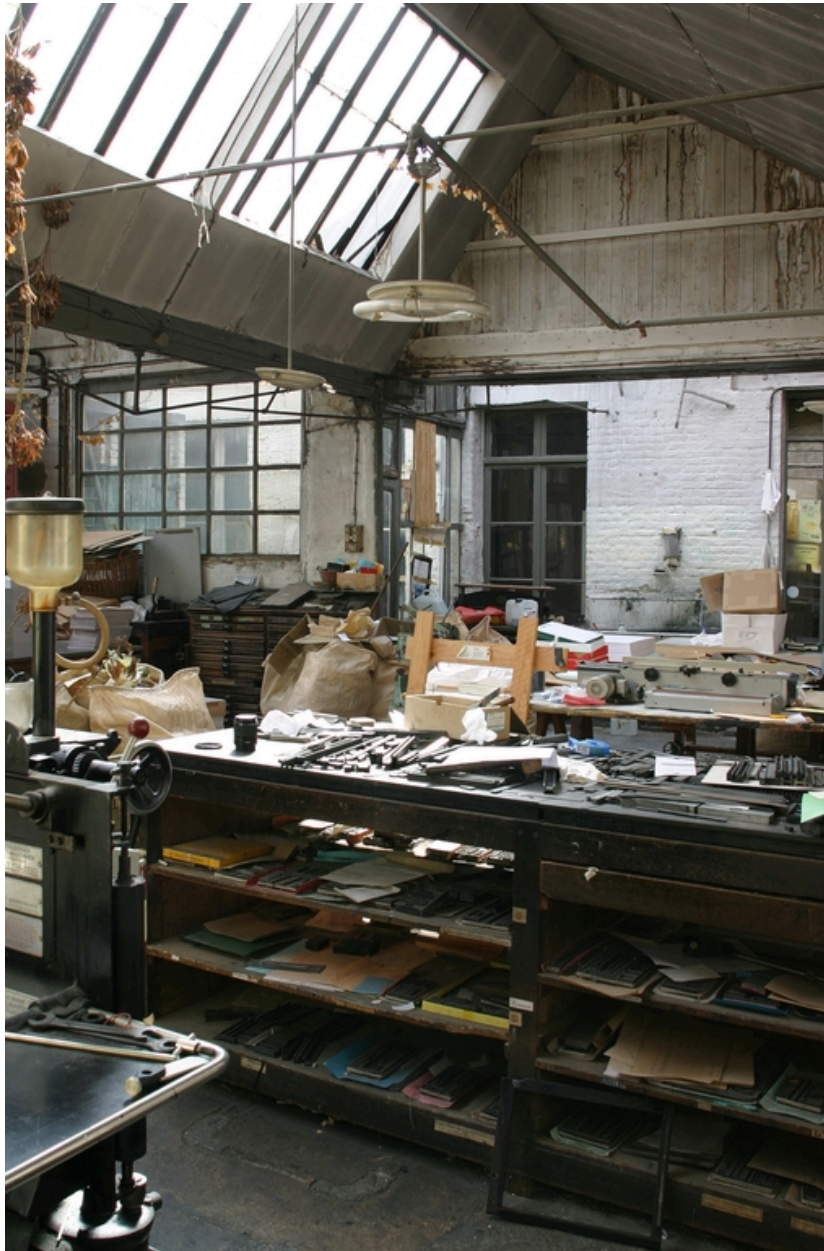
Atelier en rez-de-chaussée, couvert de sheds.
