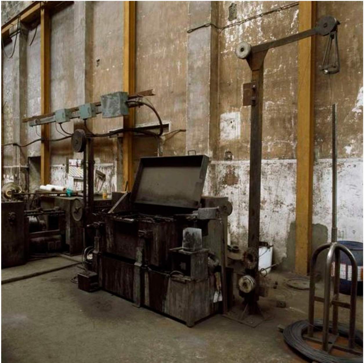
Machine à tréfiler.
