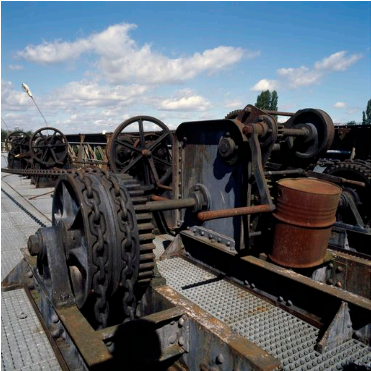
Sarron : détail du treuil de relevage.
