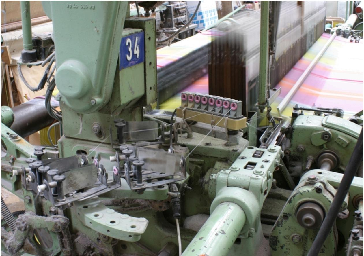
Les deux fils de trame sont conduits vers la lance d'entrée. A l'arrière-plan, la chaîne. De gauche à droite, les casse-chaînes, les lames et le peigne.
