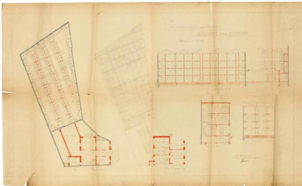
Plan et coupes de l'ensemble de l'édifice par Léonce Hainez, 20 août 1906. À noter sur ce projet l'apparition de la salle de triage, les escaliers en colimaçon aux angles du dépôt ainsi que les passerelles en dalles de verre (AD Nord ; 4 N 628).
