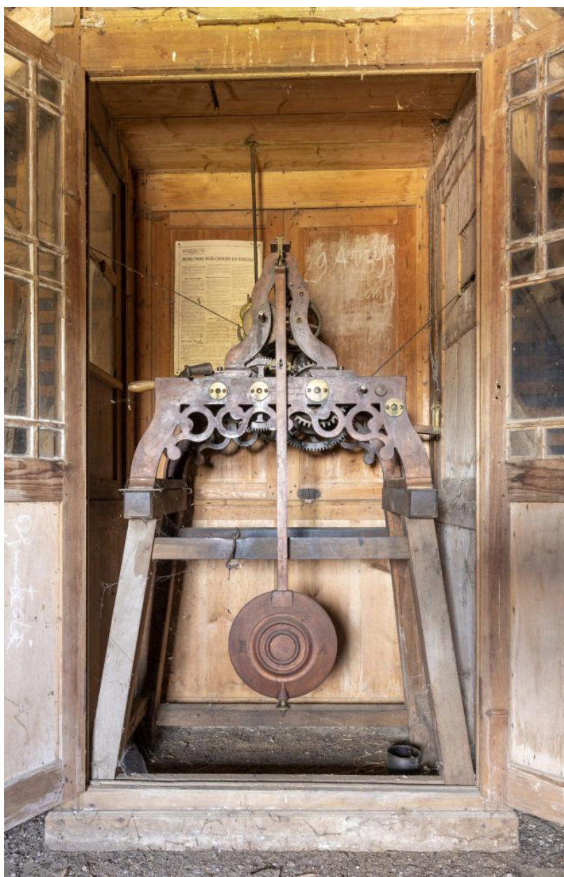
Mécanisme d'horloge signé "RENARD A FERRIERE 1882".
