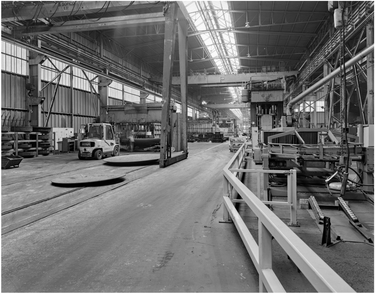
Hall 5 : la finition des fonds et l'ajustage, la presse à froid Raskin (premier plan, à droite).
