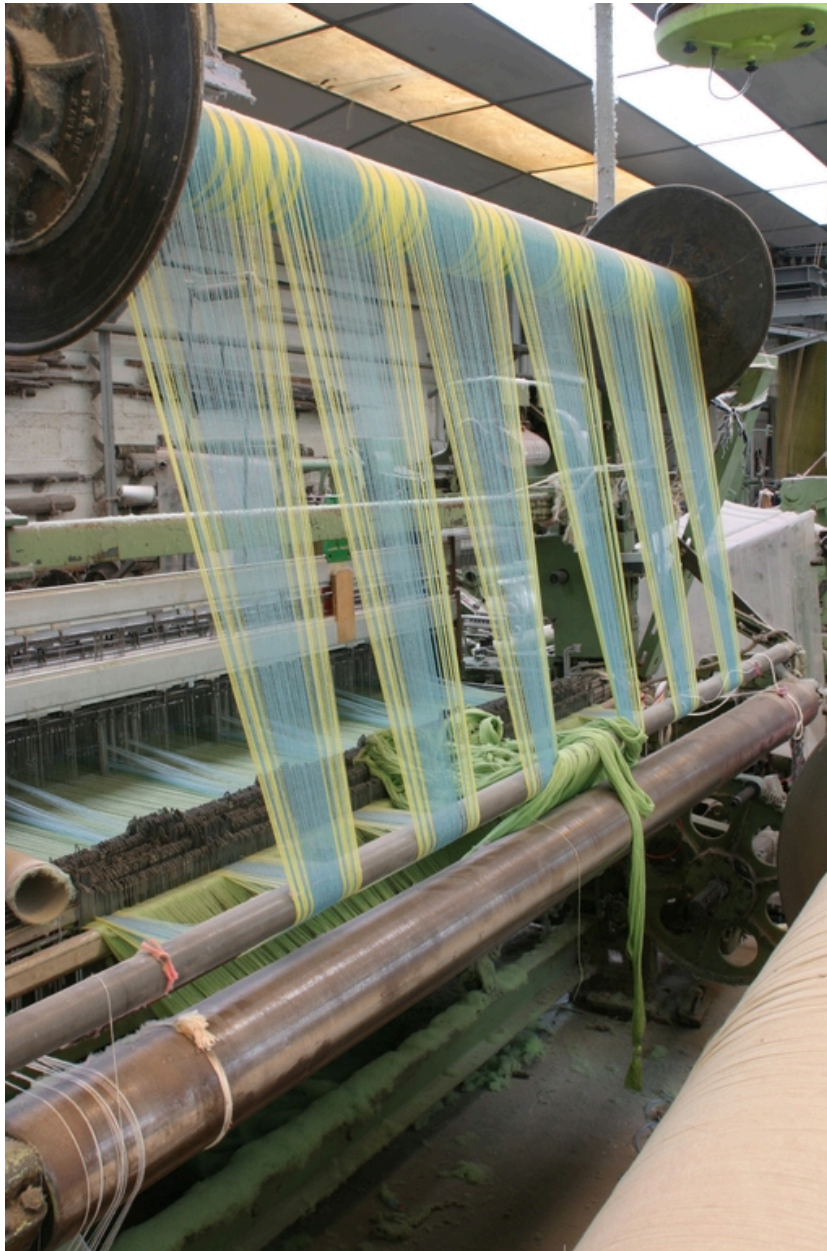
Machine à tisser à pinces montée avec deux ensouples (l'une est en cours d'installation).
