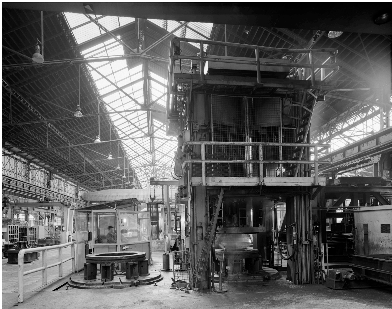
Hall 7 : la presse de 1 500 tonnes, la face arrière.
