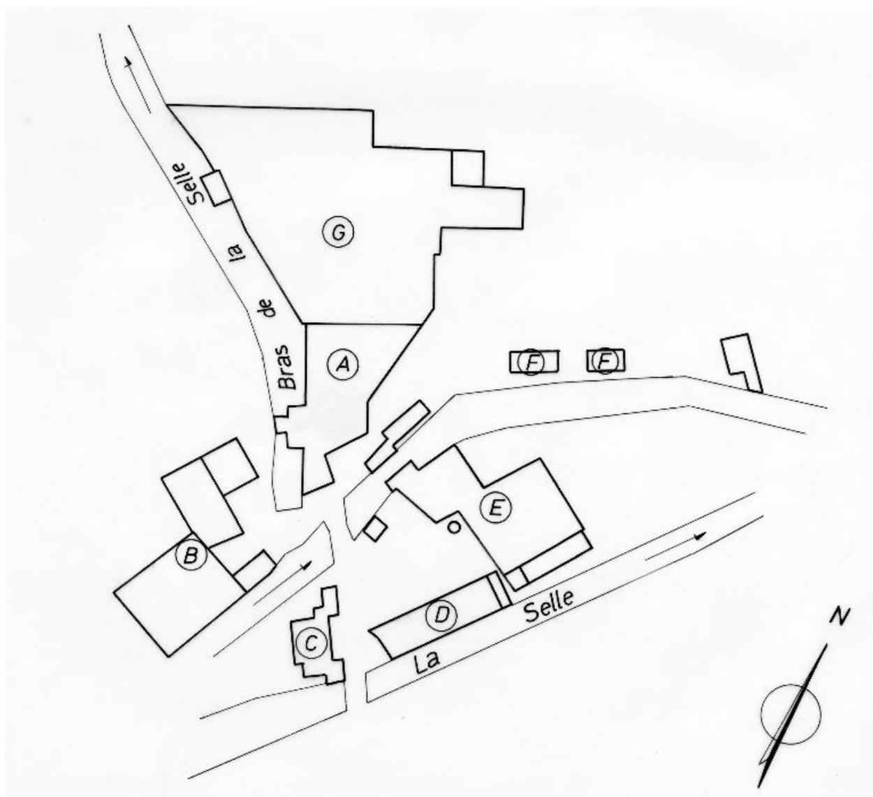
Schéma de situation : A.E. Ateliers de fabrication et bâtiment d'eau, B.G. Ateliers de fabrication, C. Logement patronal, D.F. Remise.
