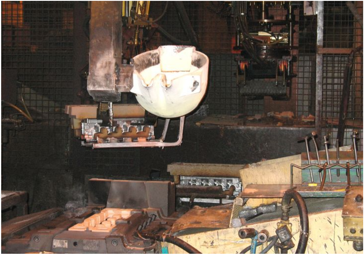
Le creuset prêt à verser l'aluminium en fusion dans les noyaux.
