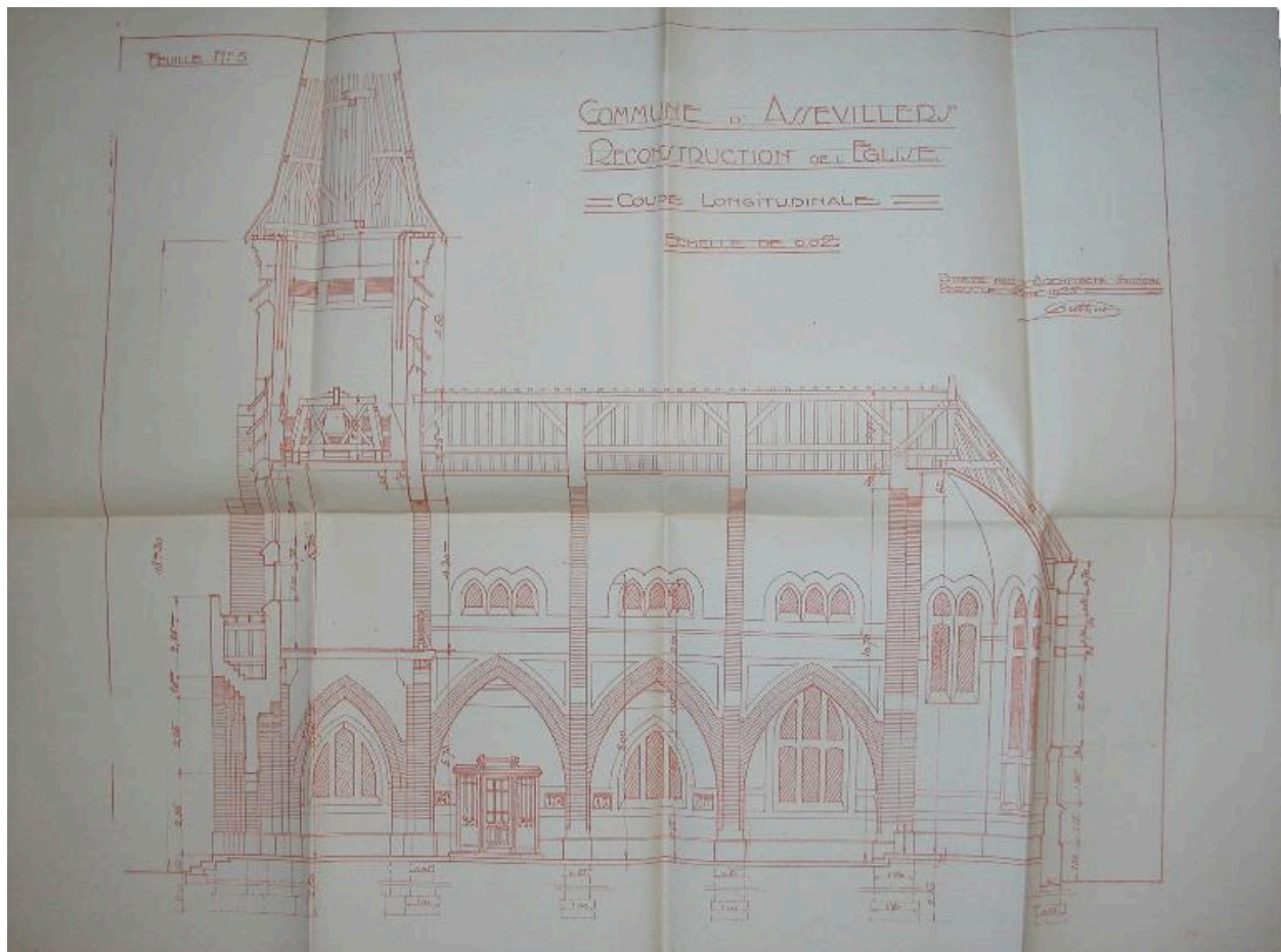
Projet de reconstruction de l'église : coupe longitudinale, feuille 5, Louis Duthoit, juin 1925 (AD Somme ; 10 R 140).
