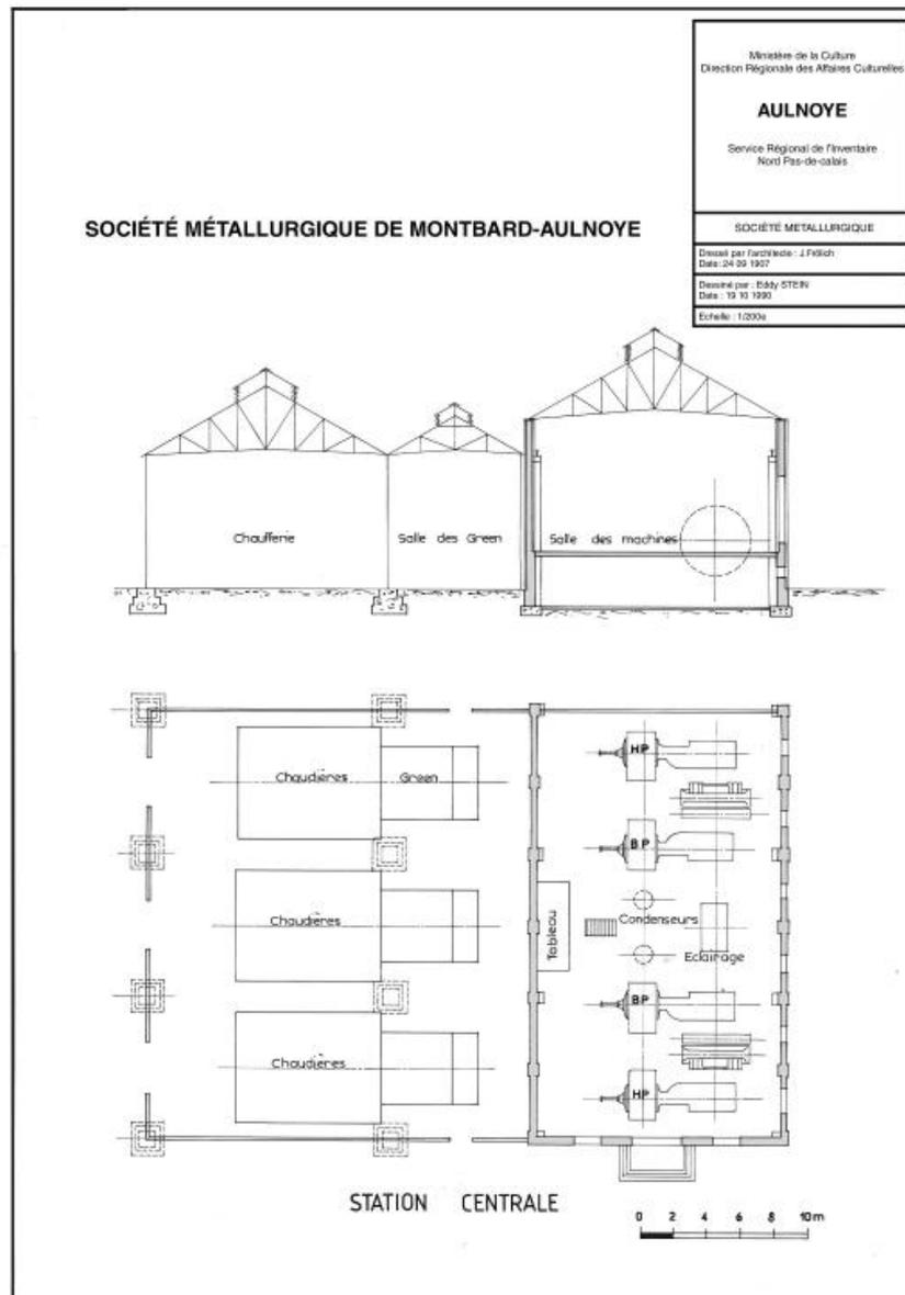
Plan et coupe de la centrale thermique dressés par l'architecte J. Frölich, 1907 (Usine B) (AD Nord ; M417720).
