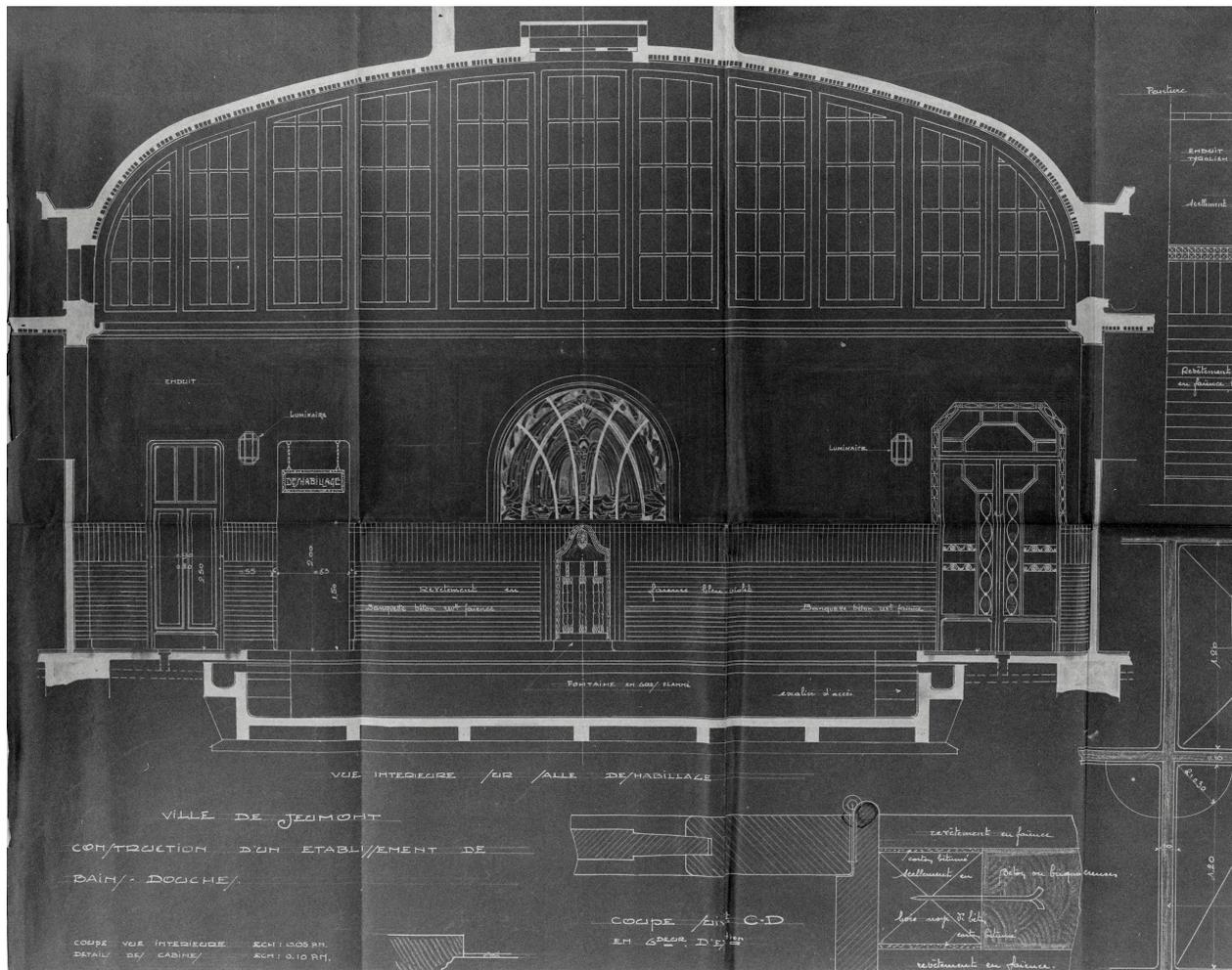
Coupe transversale, avec projet de décor : fontaine et céramique (partiellement réalisé).
