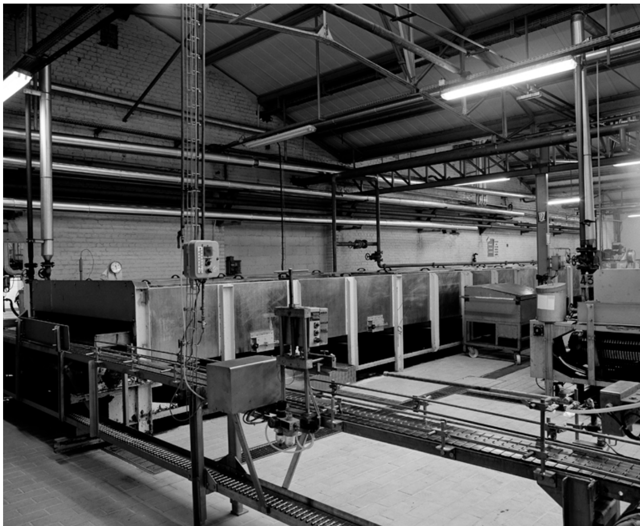
Machine servant à pasteuriser les pots.
