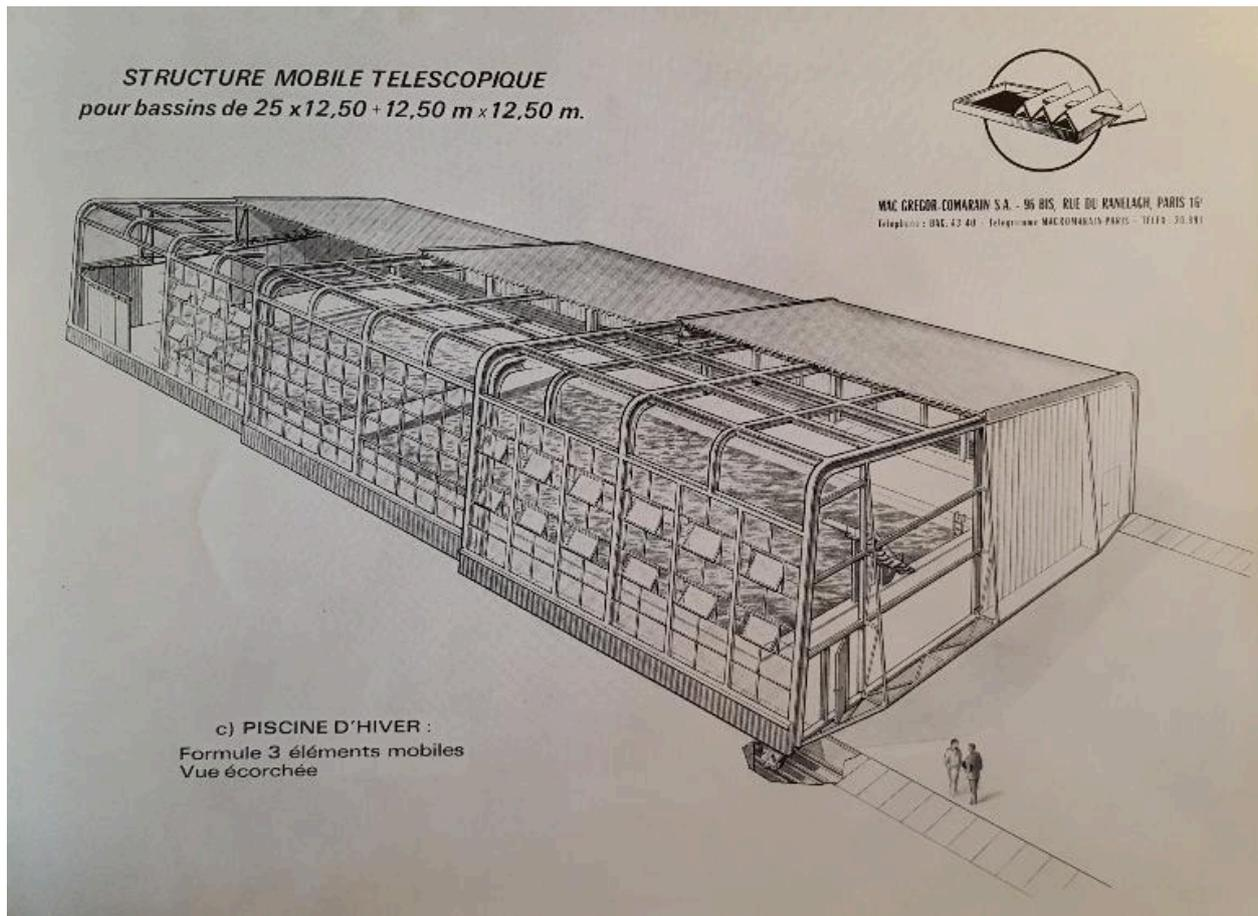
Dessin (vue écorchée) montrant une possibilité d'adaptation de la structure mobile télescopique MacGregor-Comarain à une piscine d'hiver à deux bassins (AN ; 19940528/1).
