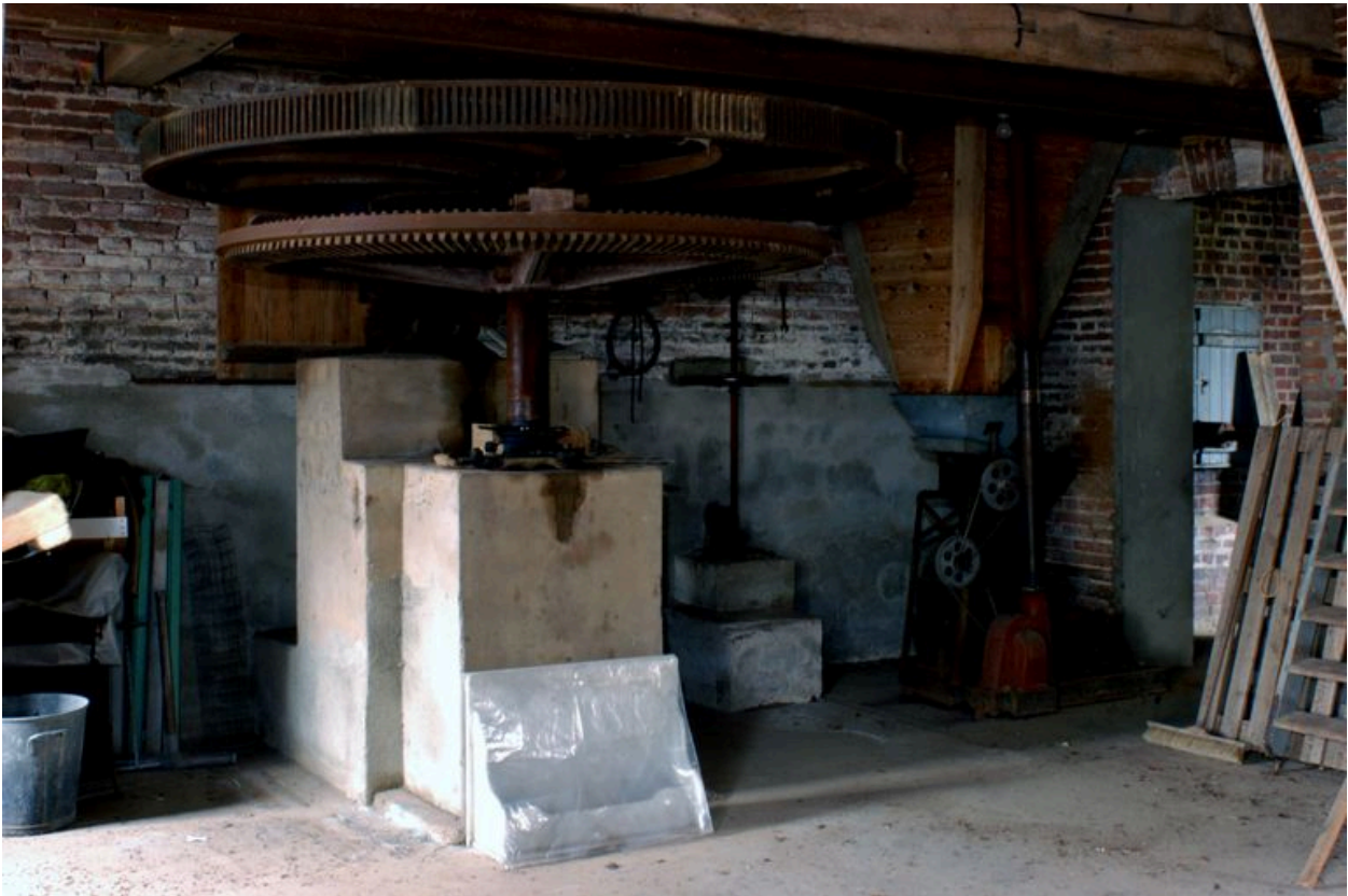
Intérieur de l'atelier de fabrication, vue d'ensemble du beffroi et du grand volant de transmission.
