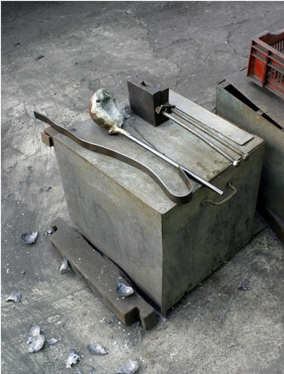
Outils pour prélever des échantillons de fonte à des fins d'analyses et d'essais.
