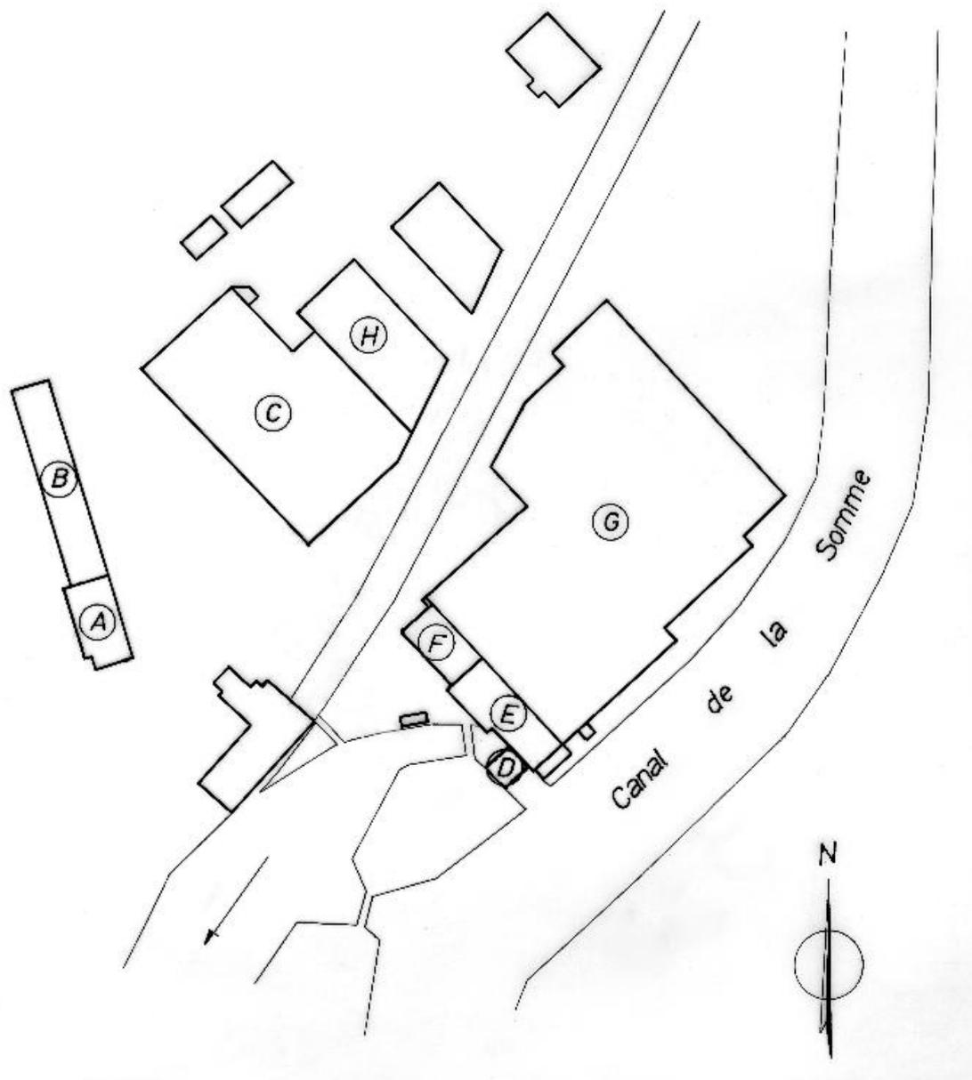
Schéma de situation : A. Conciergerie, B. Ecuries, entrepôts, C. Magasin industriel, D. Bâtiment d'eau, E. Chaufferie, salle des machines, F. Bureau, G. Ateliers de filature, H. Atelier de teinture.
