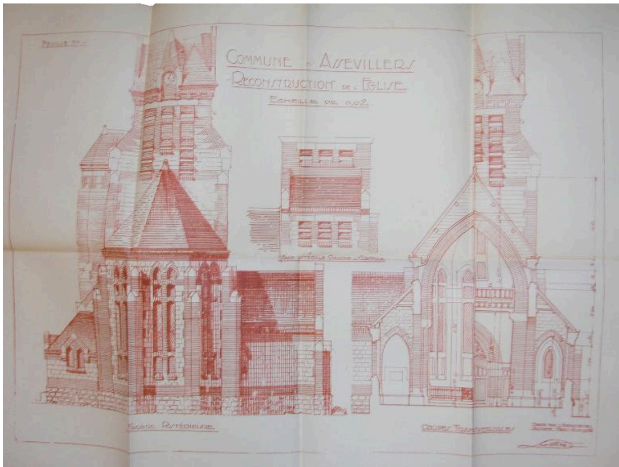
Projet de reconstruction de l'église : façade postérieure et coupe transversale, feuille 6, Louis Duthoit, juin 1925 (AD Somme ; 10 R 140).
