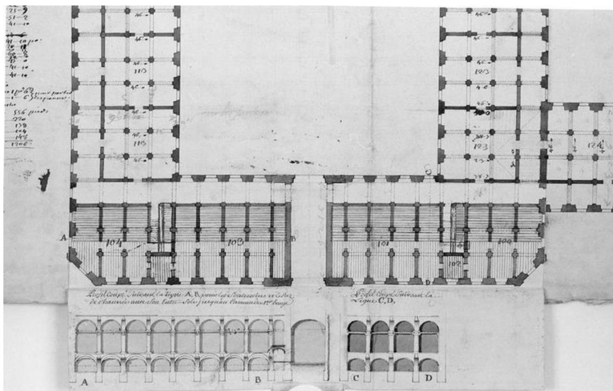
Projet de construction, 1er étage, plan de distribution générale non signé, daté du 4 octobre 1750 (AD Nord ; C 5802) : détail du bâtiment fermant la cour d'honneur sur l'avant avec la retombe montrant les plan et coupe de l'étage entresolé de ce bâtiment dépliée, ce qui montre les plan et coupe de cet étage entresolé.
