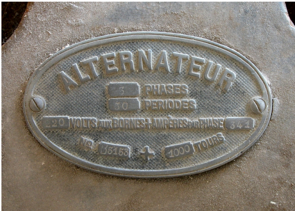
Plaque signalétique de l'alternateur du générateur.
