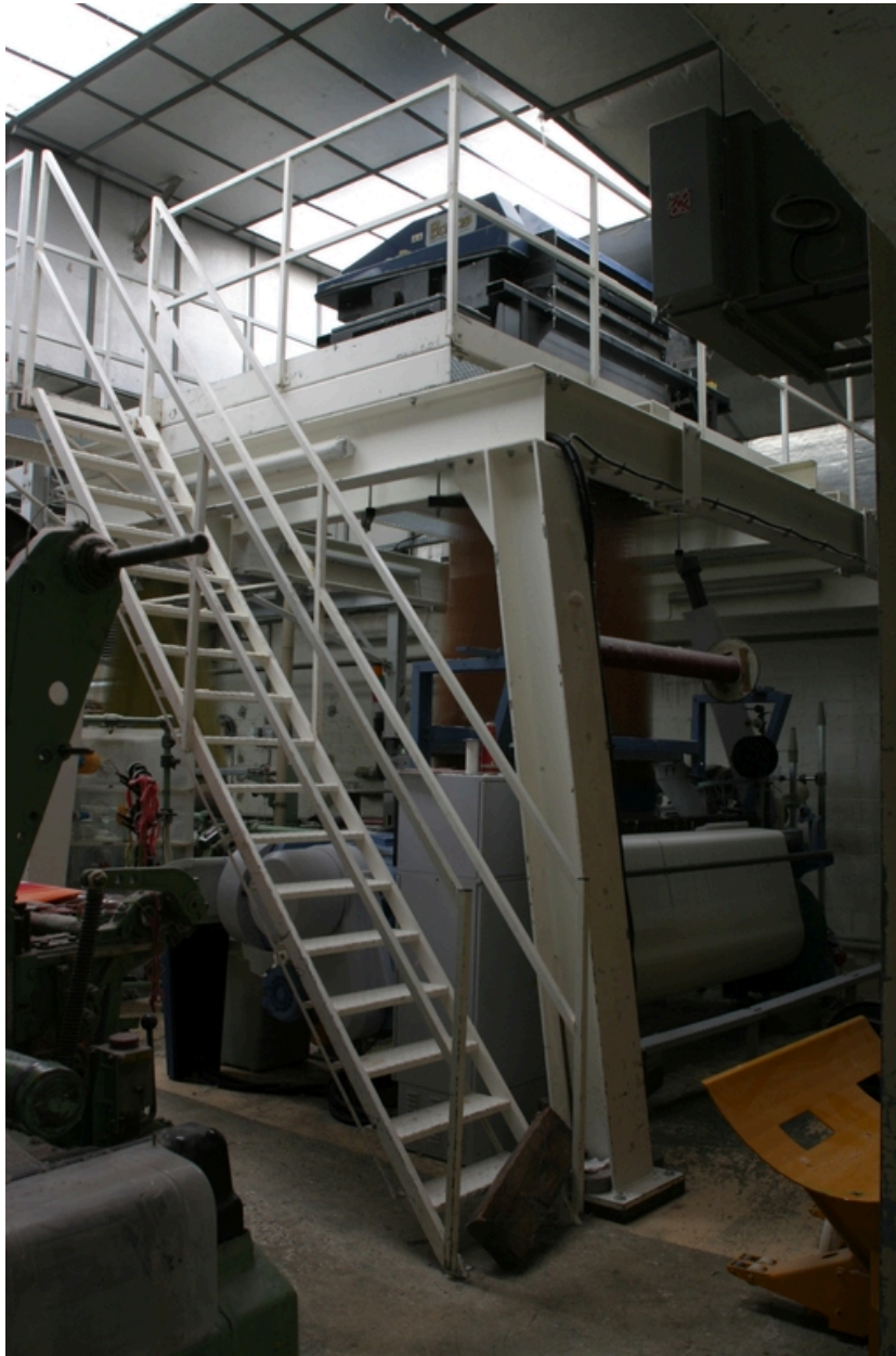
Machine à tisser à pinces à commande numérique Sulzer Textil G6300, surmontée de sa mécanique Jacquard.
