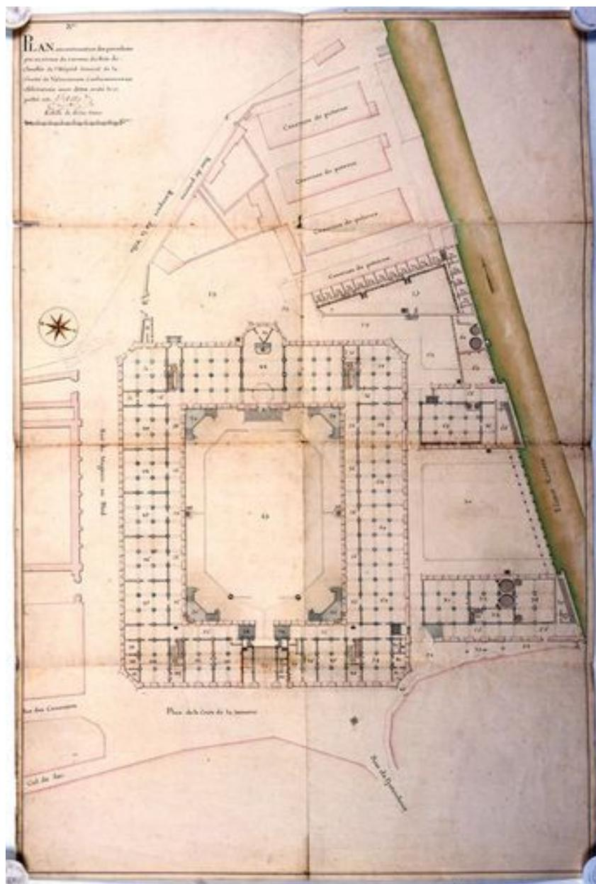
Projet de construction, rez-de-chaussée, plan de distribution générale par l'ingénieur Havez, daté du 15 juillet 1751 (AD Nord ; C 5802).
