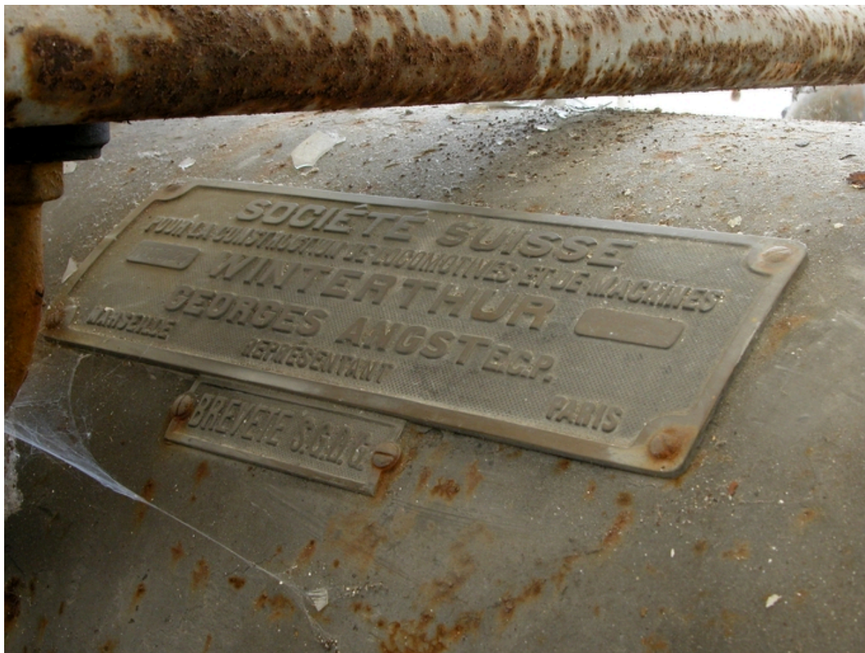
Plaque signalétique apposée sur l'un des deux moteurs de la machine.
