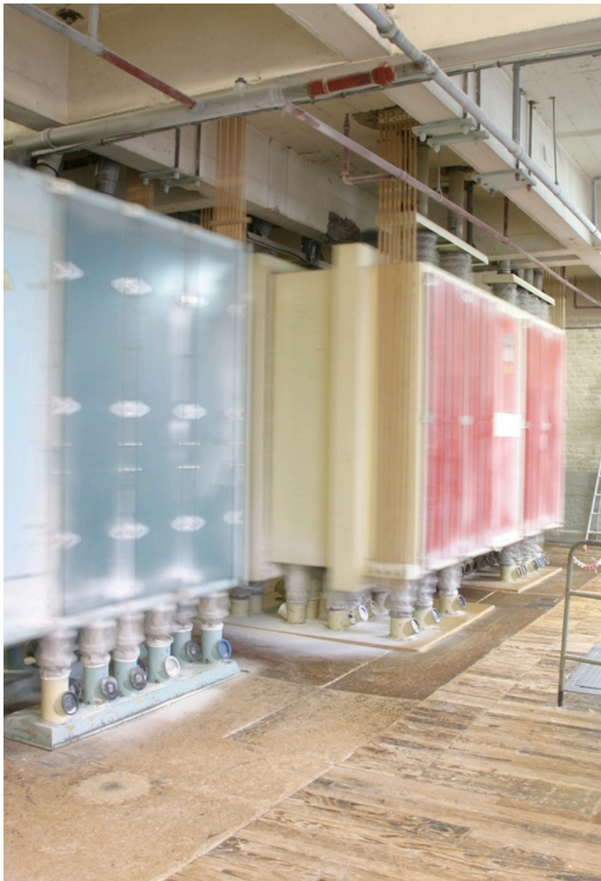
Quatrième étage de la minoterie : plansichters.
