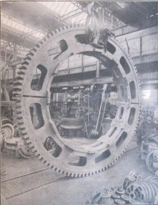
Couronne dentée en deux pièces pour four rotatif, coulée d'un seul jet et coupée à la fonte. Diamètre 4<sup>m</sup>500 — Poids 41.300 kilos.
