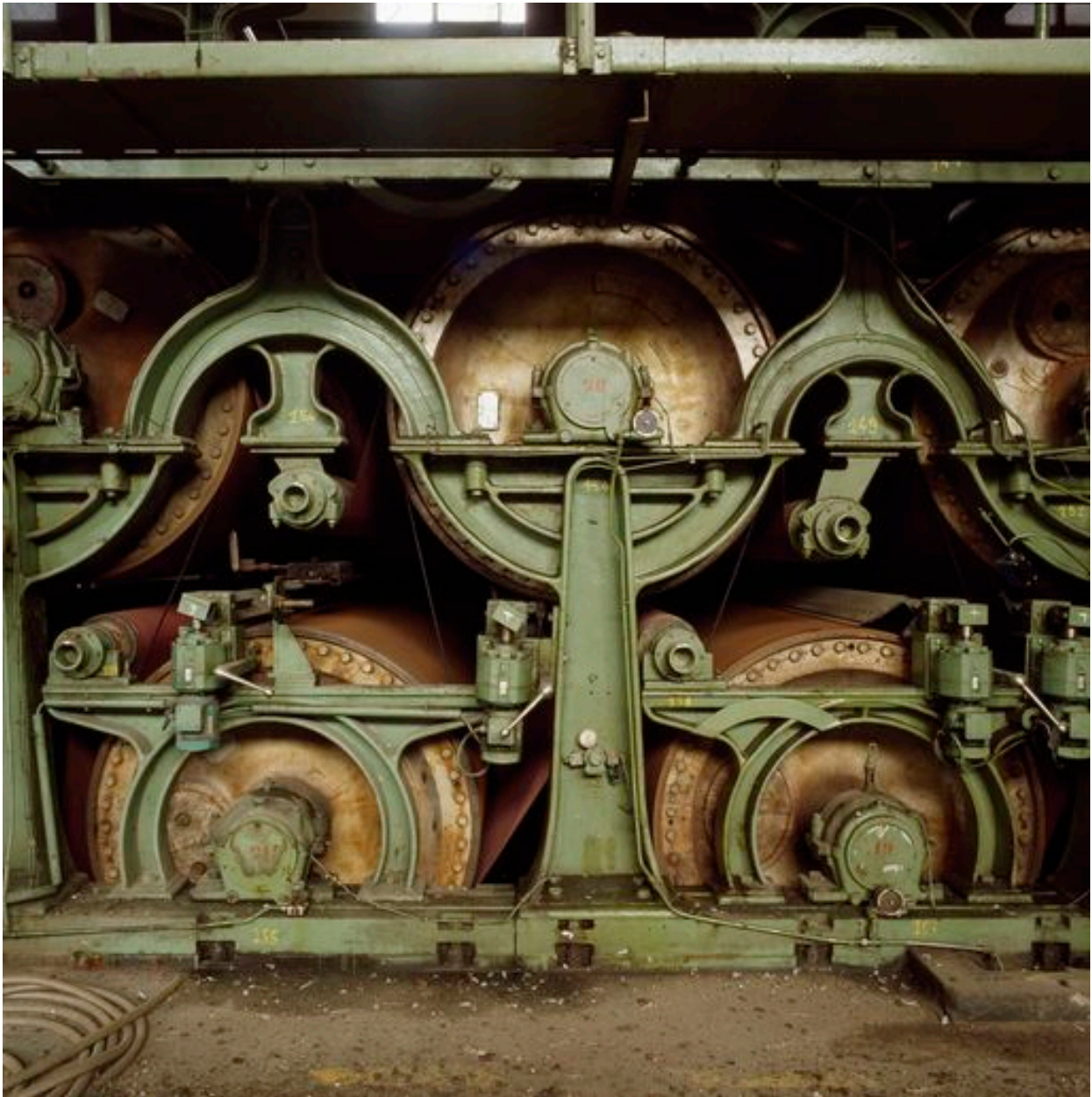
Détail des cylindres de la machine à papier Fourdrinier.
