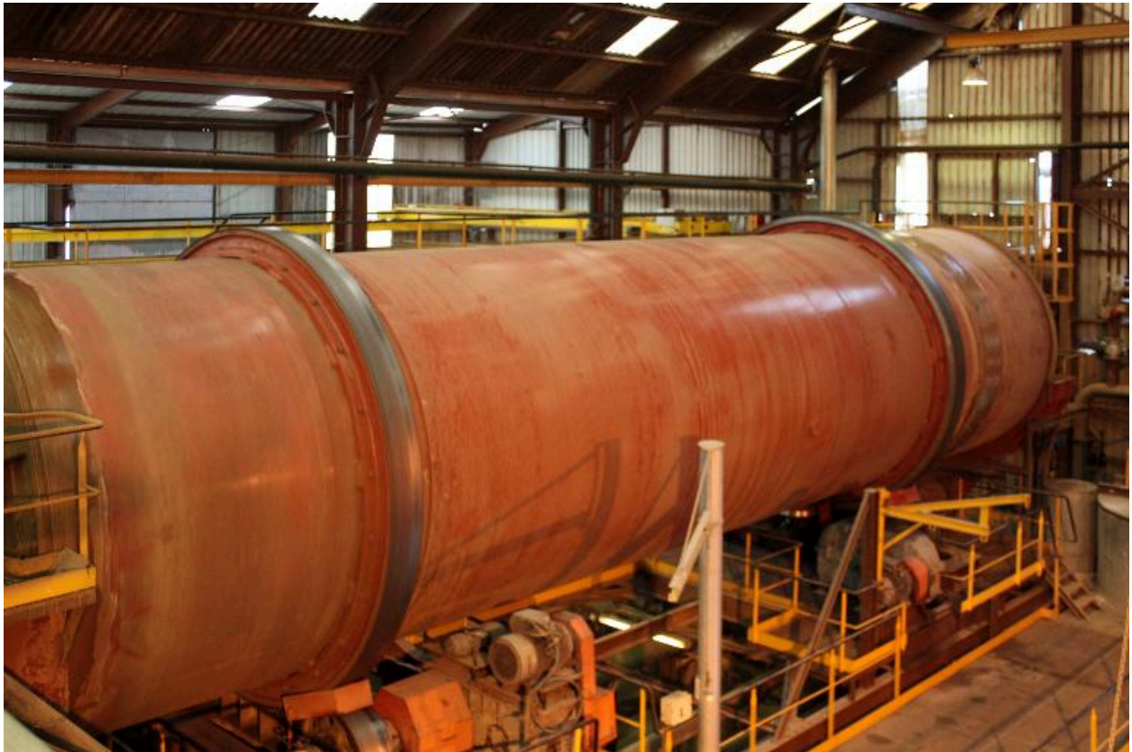
Cylindre d'épierrage et de lavage des betteraves.
