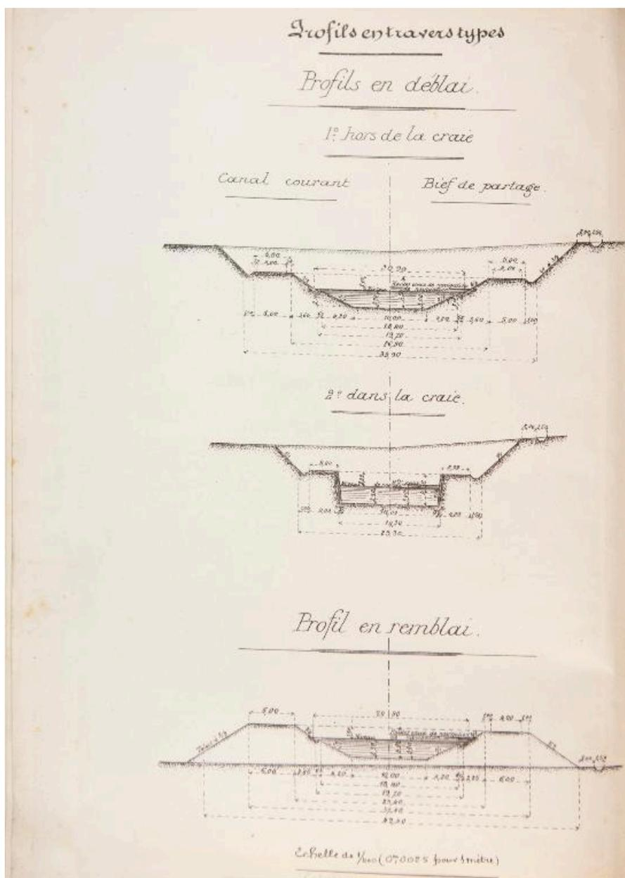
Profils en travers type, profil en déblai, profil en remblai. Notice sur l'avant-projet par G. La Rivière et D. Bourgeois, bassin houiller du Nord et du Pas-de-Calais, Exposition internationale universelle de Liège 1905, Lille, imprimerie Danel, 1905 (AD Pas-de-Calais ; S651 : 3S3326).
