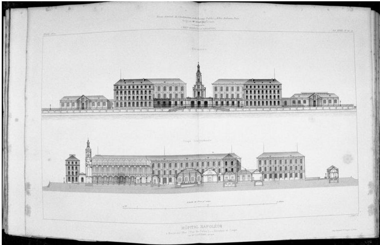
Elévation antérieure générale et coupe longitudinale générale passant par l'axe du vaisseau central de la chapelle, vue d'ensemble. Rev. gén. de l'arch., t. XXVIII, pl. 20-21.
