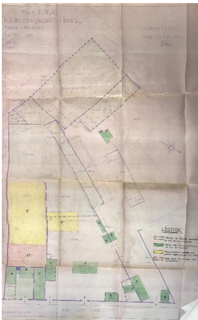
Plan de reconstruction de l'usine de bonneterie B.V.R à Corbie [en vert clair : partie de l'usine construite en dur et non réparée ; en vert foncé : partie de l'usine construite en dur et réparée ; en jaune : construction actuelle prévue ; en rose : partie dont les travaux sont commencés], par M. Thorel, 29 novembre 1941 (AD Somme ; 1254 W 154).
