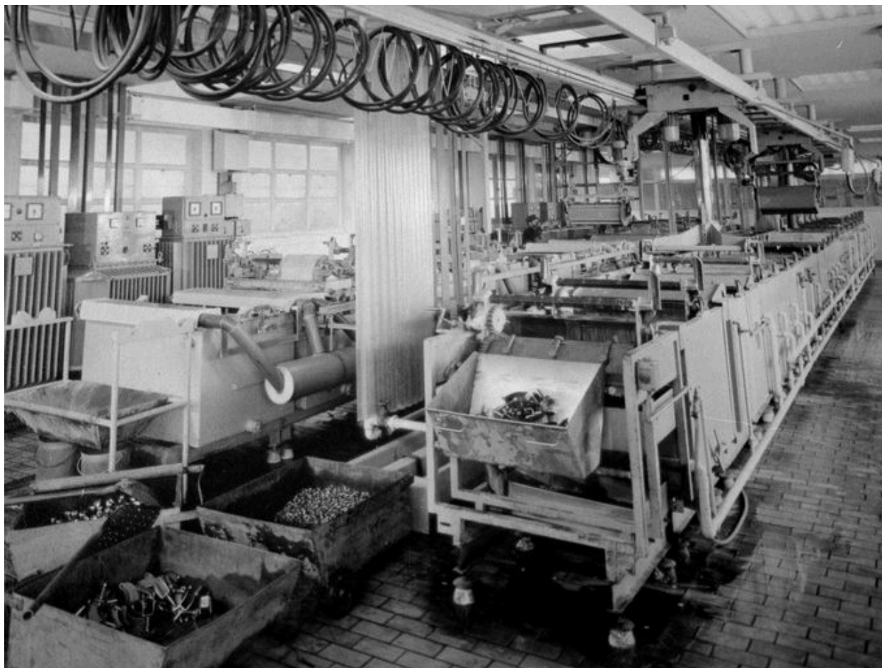
Chaîne tonneau d'electro-zingage des pièces métalliques utilisées dans la fabrication des roulettes, vers 1970 (AP).
