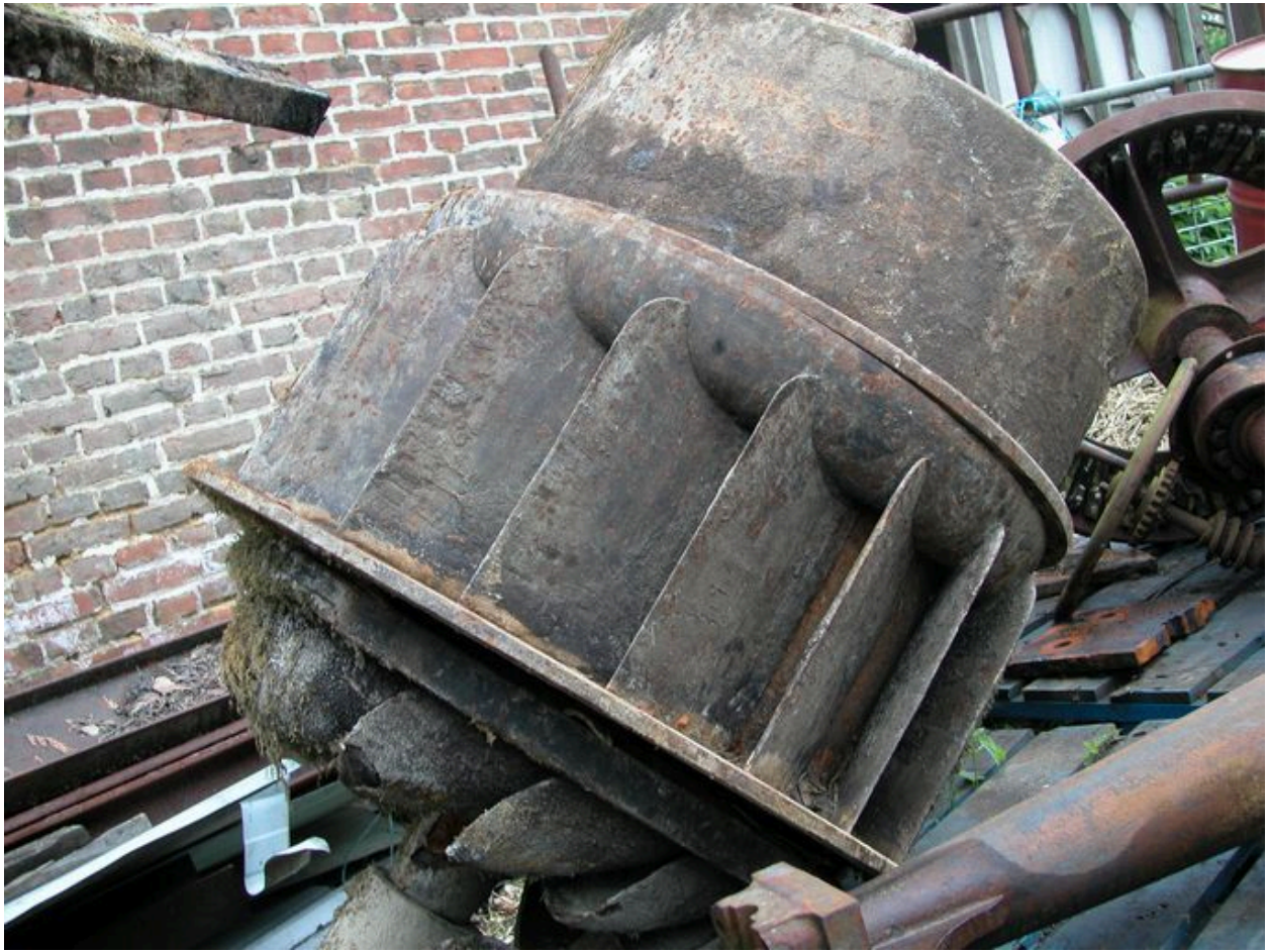
Vue d'ensemble de la turbine démontée.
