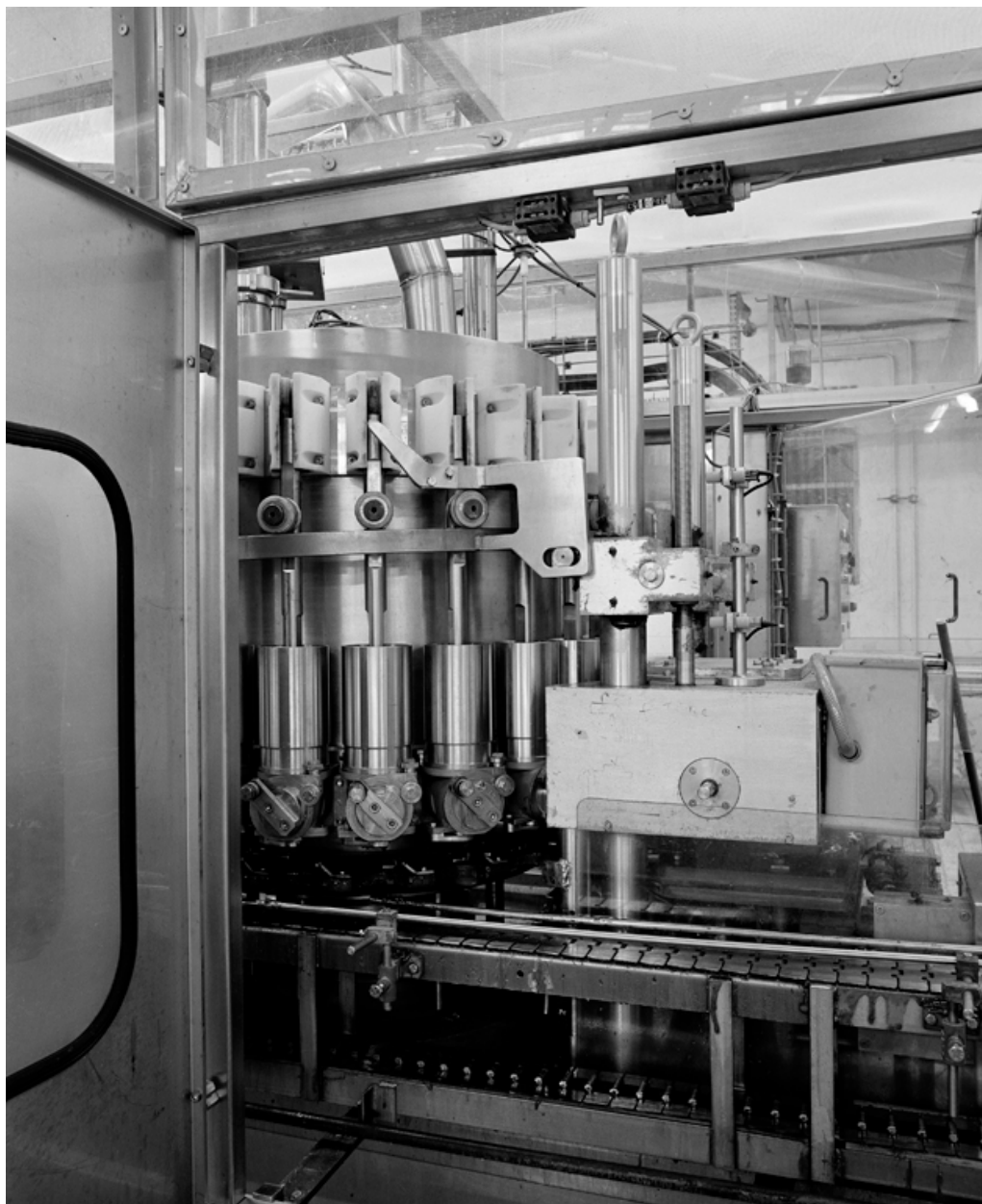
Vue de la machine qui dose la confiture dans les pots de verre.
