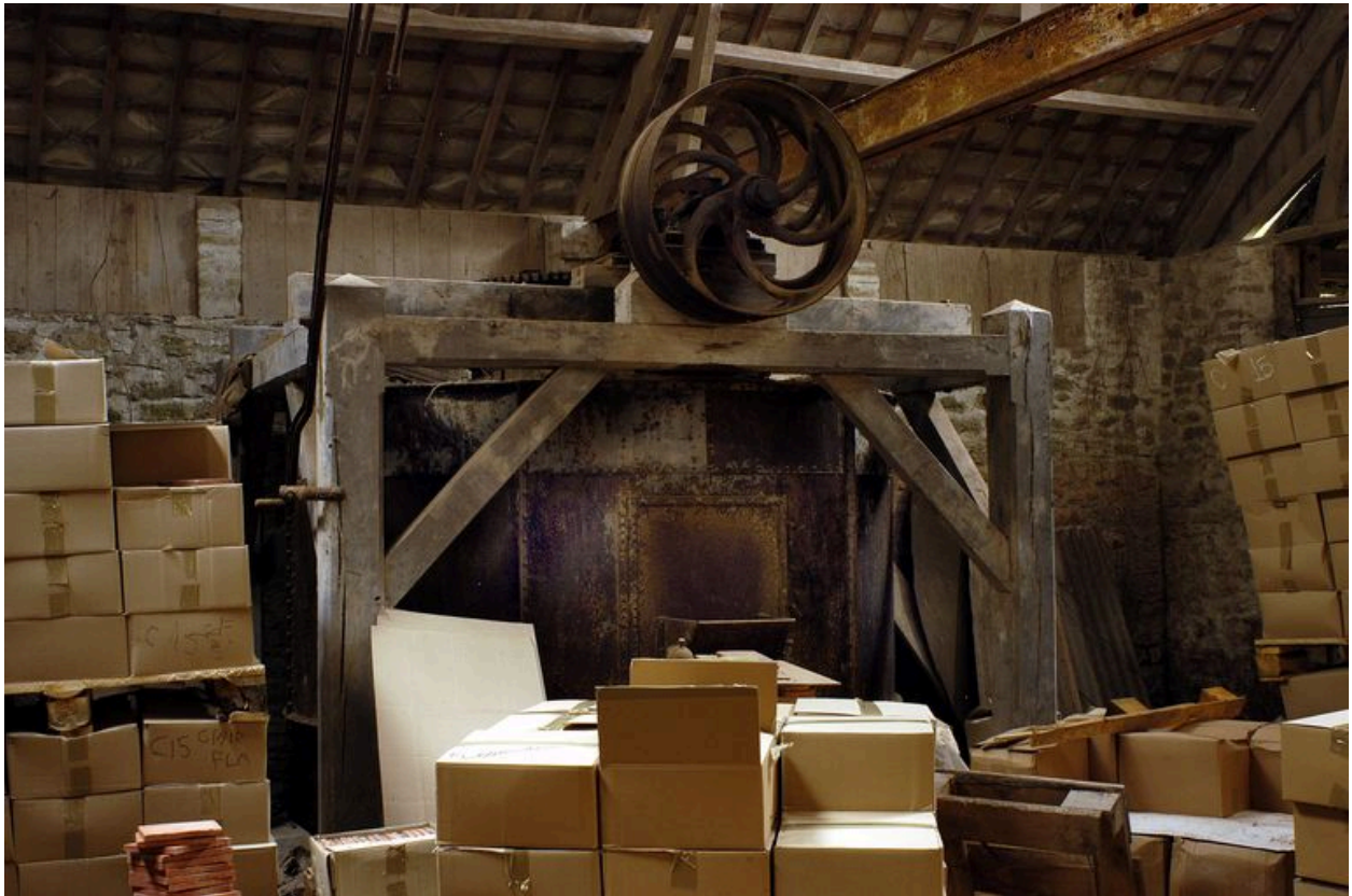
Broyeur à terre.
