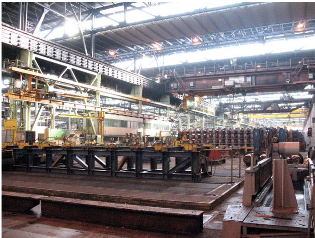
Atelier abritant le laminoir : rectifieuses et skin-pass (à l'arrêt).
